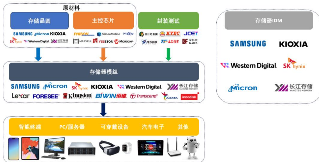
图表 12：存储器产业链图示
