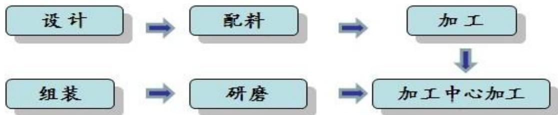
图表 6：塑料新材料生产工艺流程图
