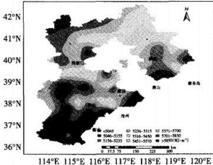
从上图可以看出，邯郸以南少数地区的水平面太阳总辐射平均年总量介于  $4814-5040\text{MJ} \cdot \text{m}^{-2}$  之间，属于太阳能资源丰富区；河北省其他地区的水平面太阳总辐射平均年总量  $>5040\text{MJ} \cdot \text{m}^{-2}$ ，太阳能资源十分丰富；总体而言，河北省太阳能资源开发利用潜力巨大。
