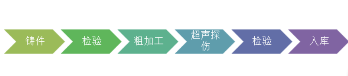
图表 2：工艺用往复式压缩机配件生产工艺流程
