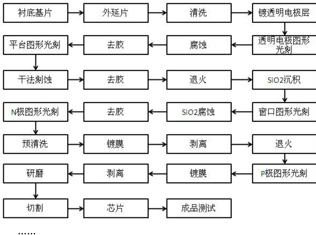
图表 7：LED 芯片工艺技术方案
